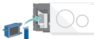
L'air est soigneusement purifié au travers d'un filtre alvéolé céramique. Un ventilateur silencieux renvoie l'air purifié dans la pièce.
