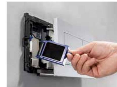
↑ Le module Geberit DuoFresh aspire l'air directement dans la cuvette de WC et le purifie à travers un filtre alvéolé céramique. Grâce à un capteur de proximité, l'absorption des odeurs et l'éclairage d'orientation discret sont activés automatiquement dès qu'une personne s'approche du WC.
